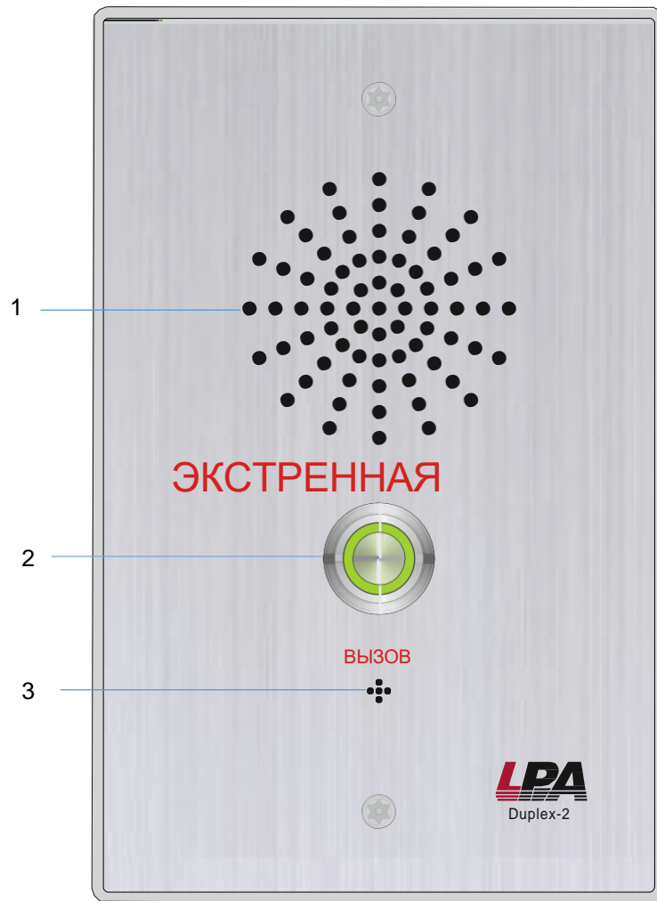
Рис. 3.3 Передняя панель вызывной панели
